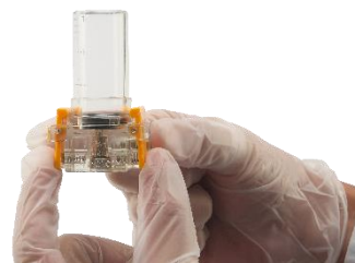
⑥今一度レバーが円筒キャップ 下部をしっかりとキャッチして いるか確認します
