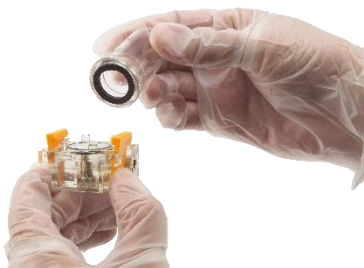
④レバーをつまみ円筒キャップを フィルター上にセットし
