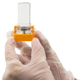
①ホルダー下部のストッパーを抜き
